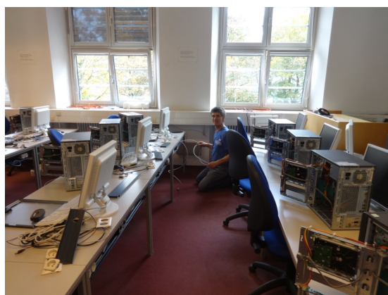
Abbildung 19: PC-Pool HB-111 zu Beginn der Aufrüstungsaktion: zur Vorbereitung auf den Komponentenaustausch werden alle PCs geöffnet und sämtliche Anschlusskabel entfernt. Bei dieser Gelegenheit wird auch der angesammelte Staub herausgesaugt.
