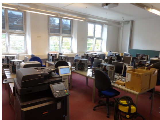
Abbildung 19: PC-Pool HB-111 zu Beginn der Aufrüstungsaktion: zur Vorbereitung auf den Komponentenaustausch werden alle PCs geöffnet und sämtliche Anschlusskabel entfernt. Bei dieser Gelegenheit wird auch der angesammelte Staub herausgesaugt.
