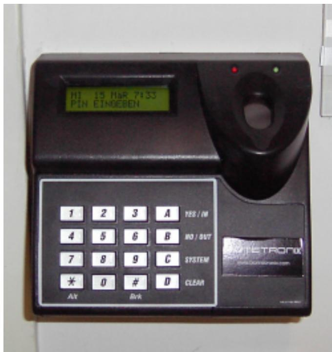
Bei ausreichend großer Übereinstimmung mit dem hinterlegten Fingerabdruck entsperrt der Fingerabdruck-Scanner die Türverriegelung und die Tür kann geöffnet werden. Sollte wegen ungünstiger Positionierung der Fingerkuppe oder zu niedriger Fingertemperatur ein erster Identifizierungsversuch scheitern, so kann das Scannen des Fingerabdrucks noch bis zu zwei weitere Male wiederholt werden, ehe der Vorgang erneut mit der PIN-Eingabe begonnen werden müsste.
