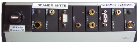
Abb. 3: Anschlussfeld für Laptops, Audio, Video, USB für den Dozenten-PC
